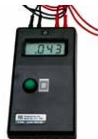
Ein Megaohm-Messgerät legt eine hohe Gleichspannung mit einer bestimmten Stromstärke an das Bauteil an und zeigt den Widerstand gegen diese Spannung an. Normale Multimeter sind nicht in der Lage, eine ausreichend hohe Spannung für eine zulässige Messung zu liefern.
